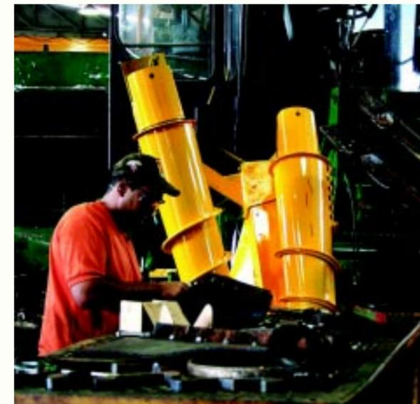
Operador de máquina, na função de operador-mantenedor, faz manutenção de colhedora na Usina da Pedra
